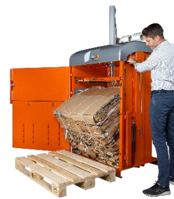
Den nya modellen 3120 kännetecknas av modern design, extra generöst inkast och semiautomatisk urbalning
